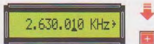
Fig.33 Per prelevare una frequenza di 2.630.010 KHz, occorre premere per 2 volte il tasto * in modo da sottolineare il secondo 0, quindi premete il tasto +.
