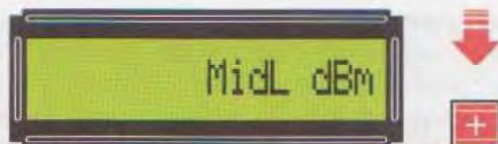
Fig.41 Per visualizzare tutti i livelli di uscita utilizzate i tasti + o -. Quando compare il livello desiderato, premete # per selezionarlo. Per uscire premete il tasto Mode.
