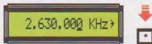
Fig.32 Se volete variare di pochi KHz la frequenza che appare sul Display, dovete premere il tasto * fino a quando non sarà sottolineato il numero da modificare.
