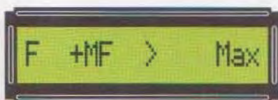
Fig.39 Se sul display appare F+MF > Max, significa che avete superato la frequenza massima di 2.800.000 KHz che questo Generatore è in grado di fornire.
