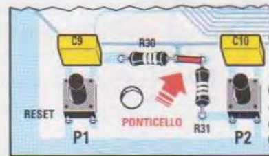
Fig.1 Per utilizzare il pulsante P2 che si trova sulla scheda di test LX.1686 eseguite un ponticello tra le resistenze R30 ed R31 .
