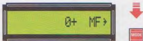
Fig.38 Il valore della MF che volete sommare o sottrarre al segnale UHF va espresso in KHz, quindi se avete una MF da 10,7 MHz dovete digitare 10700.
